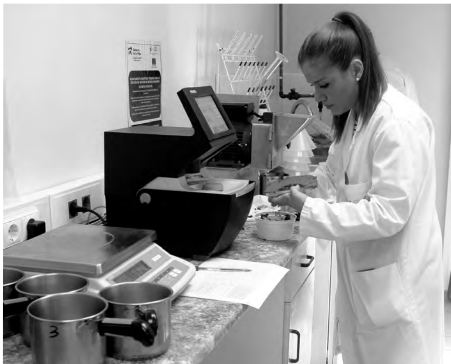
Una técnico del CTIC-CITA prepara la pasta de aceituna para medir la grasa, la acidez y la humedad con el NIR.
