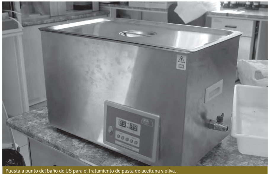
Puesta a punto del baño de US para el tratamiento de pasta de aceituna y oliva.
